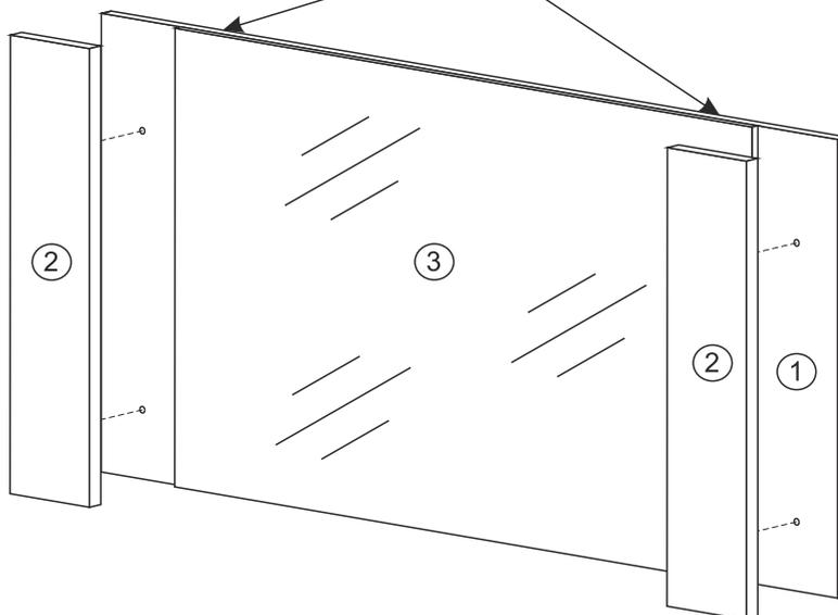
1. Сборка производится горизонтально. На задник 1 с уже приклеенным на него зеркалом 3 установить навесы и прикрепить планки МДФ при помощи шурупов 4\*25 мм. Готовое зеркало навесить на стену при помощи ранее установленных навесов и дюбелей с шурупом.
