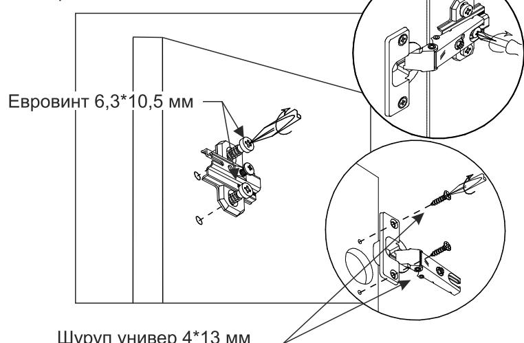
2. Сборка производится горизонтально, тыльной стороной вниз. На боковины 1 предварительно установить эксцентрики, а также ответные планки петель при помощи евровинтов 6,3\*10,5 мм. Подготовленные боковины 1 скрепить между собой вязкой 3, используя еврошурупы 7\*50 мм.
